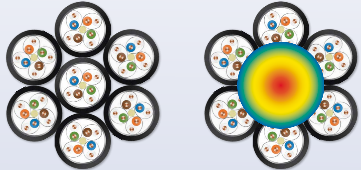
Anwendungsbeispiel für ein Ethernetkabelbündel mit PoE-Nutzung mit dabei entstehender Wärmeentwicklung
